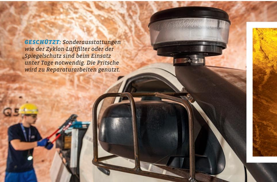
**GESCHÜTZT:** Sonderausstattungen wie der Zyklon-Luftfilter oder der Spiegelschutz sind beim Einsatz unter Tage notwendig. Die Pritsche wird zu Reparaturarbeiten genutzt.
